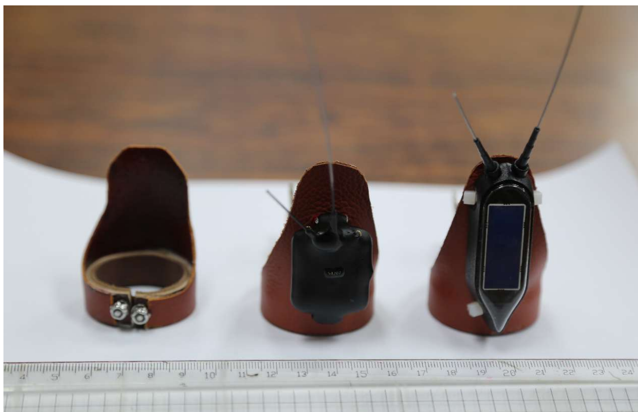
圖 4 左：皮製頸圈、中：充電式衛星發報器、右：太陽能式衛星發報器
