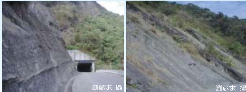
左為紅花子層的岩相之一：厚5~20公尺的厚層粉砂岩。攝於雙連堀明隧道前。 右為紅花子層的岩相之二：粉砂岩與細砂岩的巨厚互層（圖中所見為細砂岩部分），攝於十三至十四號橋間的大順向坡。
