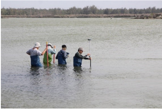
圖 4 手持 VBS-RTK 徒步測量及操筏測量水深情形。
