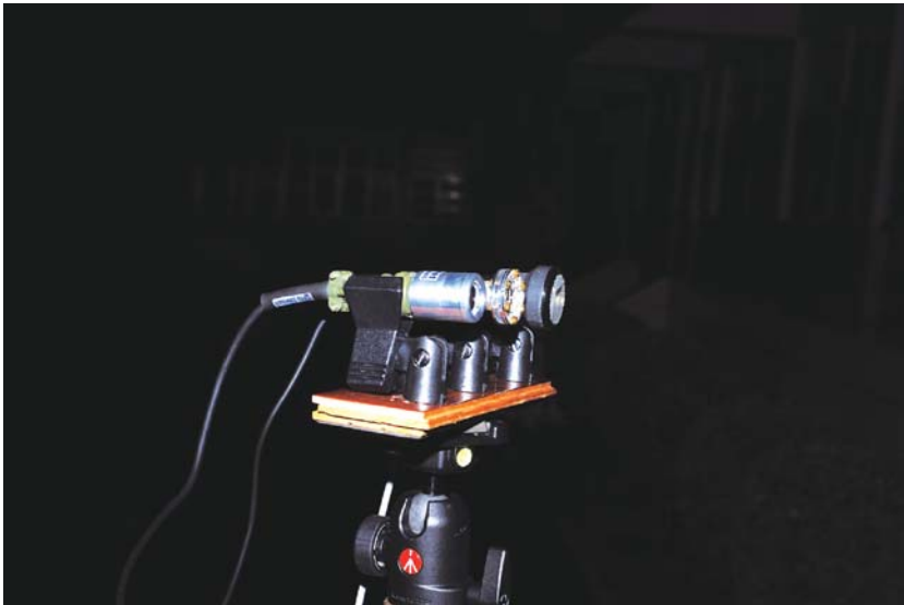
圖 1. 架設於平台上的3模組蝙蝠偵測器的麥克風,由左至右依序為 Pettersson、Avisoft、AnaBat 系統。
