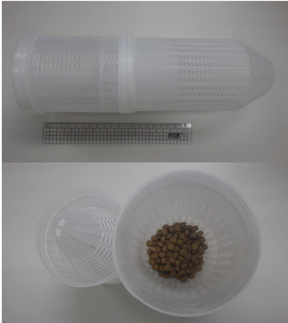
Fig. 2. The baited shrimp traps of size 30 cm (length) x 10 cm (diameter). 圖 2. 捕蟹之蝦籠，尺寸為長 30m、直徑 10m，並裝餌料誘捕。
